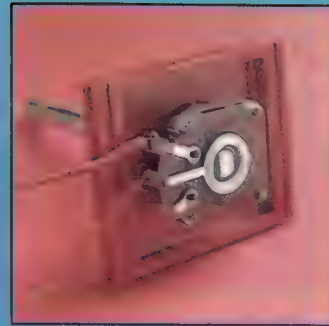
Potentiomètre Les potentiomètres servent et fournissent une réaction et communiquent la position du robot.
